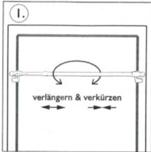
Die Gardinenstange durch Heraus- oder Hineindrehen des Innenrohrs auf die Fensterbreite anpassen. Zusätzlich zur Fensterinnenbreite 2-3 cm geben um die innenliegende Feder auf Spannung zu halten.
