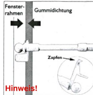
Bei rechteckigen Rahmen dienen die Gummipuffer der Befestigung! Bei schrägen Rahmen die Gummipuffer entfernen und die beiden Zapfen zwischen Gummidichtung und Fensterrahmen einhängen.
